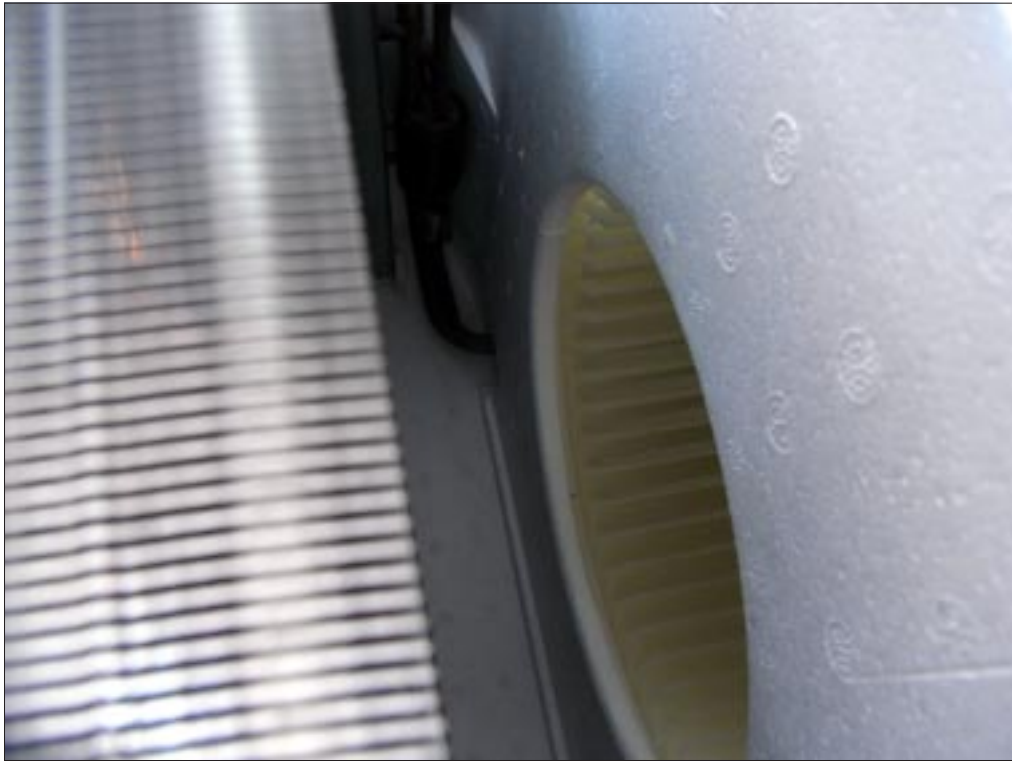
[2-b] 窗型冷氣的冷排風扇
