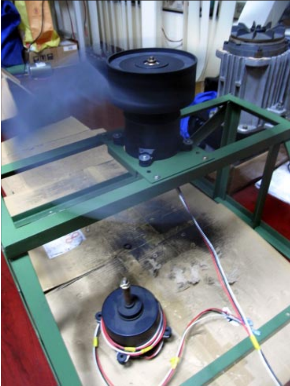
[7-b] 較大輸出的熱排風扇(測試中)，這是用在熱泵系統的排熱風扇 [圖七] 測試中的 Sensorless 熱排風扇
