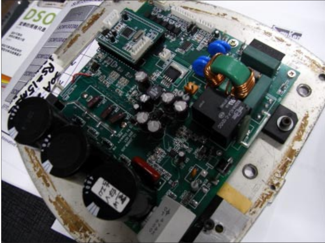
【圖三】附霍爾感測元件的無刷馬達控制器，旗威科技試製品
