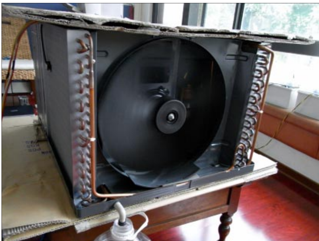
[2-a] 窗型冷氣的熱排風扇
