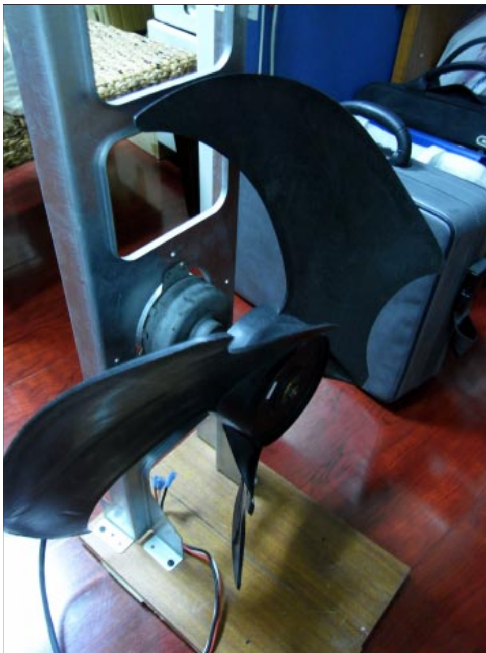
[7-a] 一般冷氣室外機用的熱排，也是無刷無感測的馬達，只有三條接線，原先是控制器內藏型的，但已被改成外接型的，由外部驅動板直接控制
