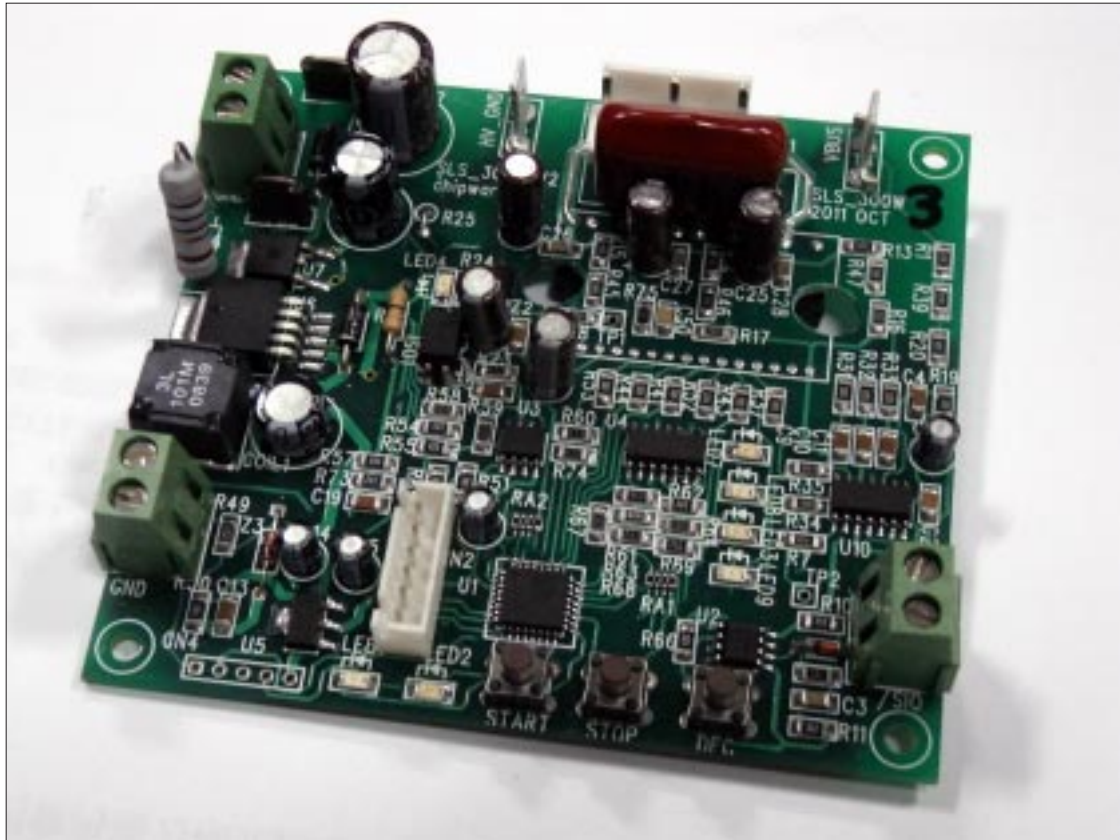
[圖五] 100W 左右有 0-10V 電壓輸入與 RS485 通訊功能的無感測風扇控制板
